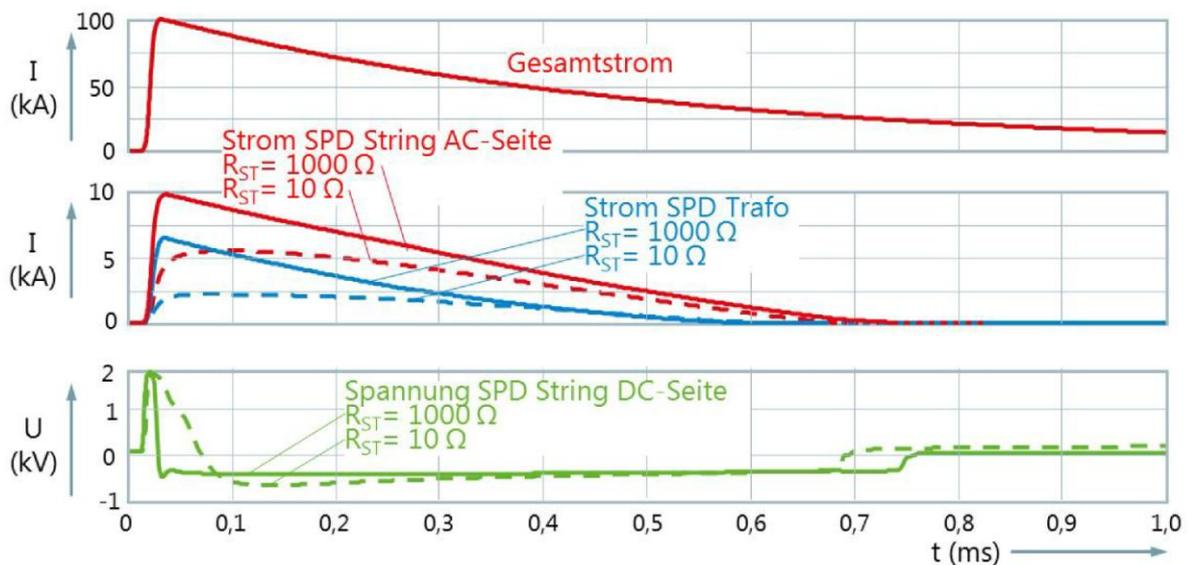
**Bild 9:** Blitzstromverteilung bei einer PV-Freiflächenanlage mit Stringwechselrichter
